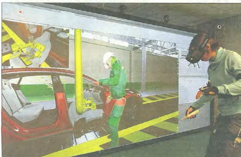
Optis a développé plusieurs logiciels: SPEOS (simulation optique), VRX (simulation expérience de conduite), HIM-Polyaéro (training virtuel) et Theia-RT (simulation en temps réel). Sur notre photo, c'est le logiciel Theia qui est utilisé pour montrer les capacités de configurateur réaliste reproduisant une voiture Tesla. (Photo DR/ Optis)
