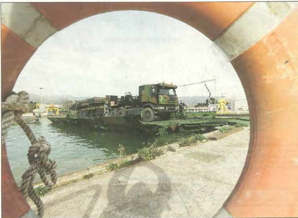
Que ce soit en pont continu, ou en «ferry», les modules de pont flottant motorisé sont d'une étonnante manœuvrabilité. (Photos Dominique Leriche)
